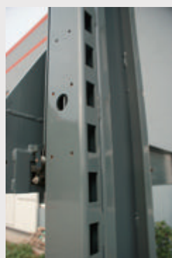
Dispositif de verrouillage dynamique avec 17 languettes de verrouillage
